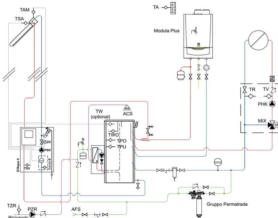
Pacchetti solari con AQUA ESPRESSO III per produzione acqua calda sanitaria e integrazione al riscaldamento (THIT2003)
