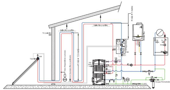
Impianto solare sottotetto con AquaSun Plus (solare su serpentina separata)
