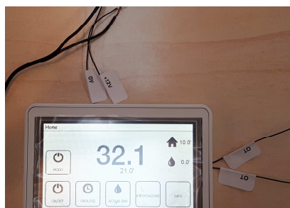
n. 4 fili per l'alimentazione e la connessione OT
