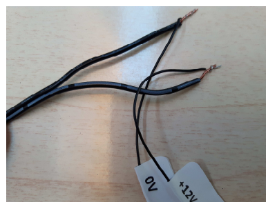
collegare +12V a filo dell'alimentatore bicolore (nero/grigio)
