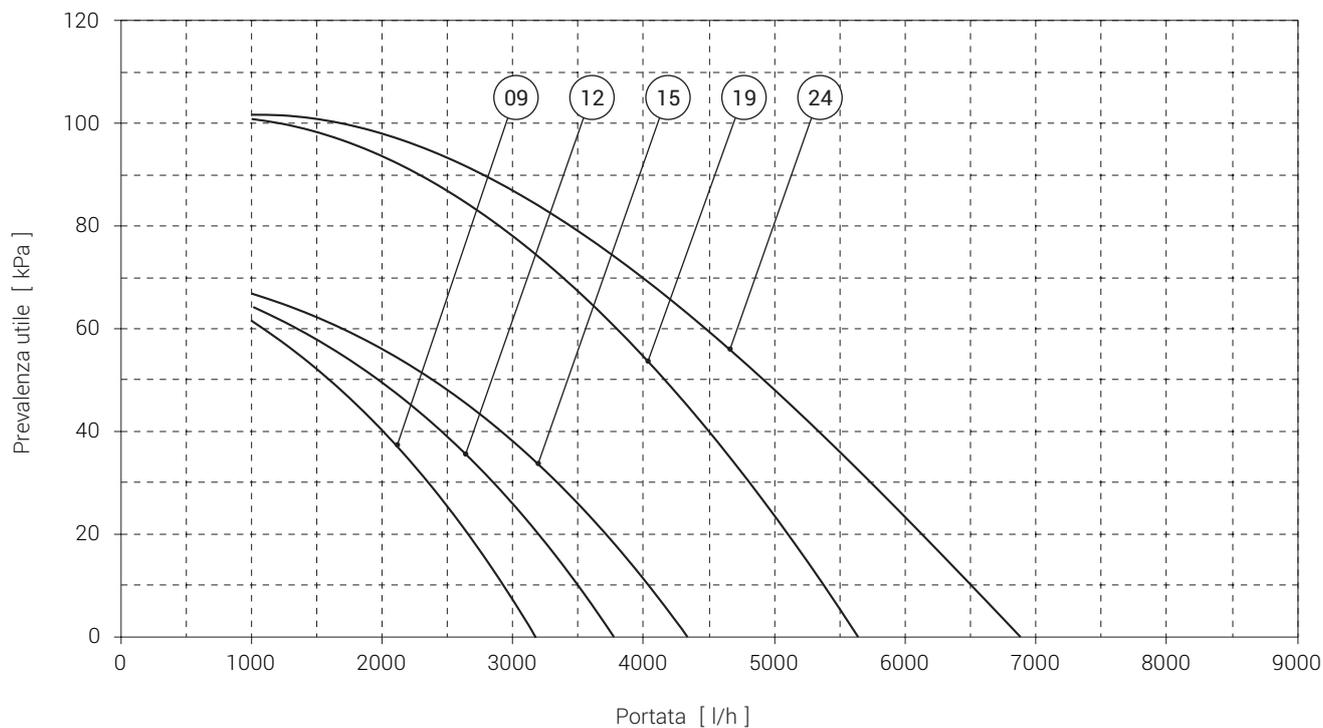
I grafici si riferiscono a unità funzionanti con acqua alla temperatura di 10°C (densità 1000 kg/m<sup>3</sup>).
