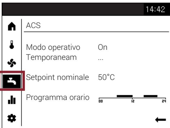
Impostando il modo operativo su "On" la pompa di calore manterrà la temperatura dell'accumulo vicina al set point nominale attivando una valvola a tre vie (**Q3**) per deviare il flusso della pompa di calore dai circuiti di riscaldamento/raffreddamento verso l'accumulo dell'acqua calda sanitaria.
