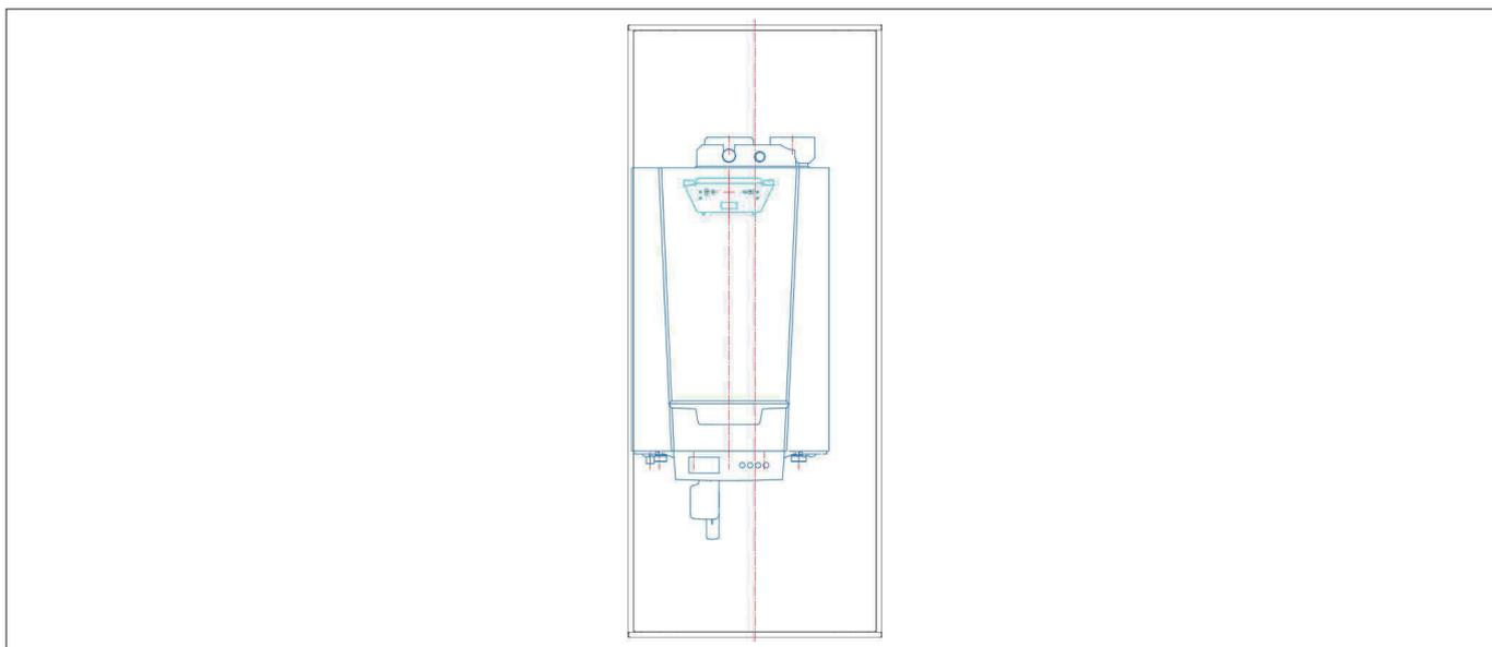
6. Montare il vaso d'espansione tramite la staffa di fissaggio inferiore nel fermacavo zincato installato al punto 3. Prima di avvitare la staffa di fissaggio superiore allo schienale tramite una delle viti in dotazione è importante che si colleghi il tubo che porta dalla caldaia al vaso d'espansione. Questa operazione si consiglia di effettuarla con vaso ancora mobile, altrimenti risulterebbe più difficoltoso.
