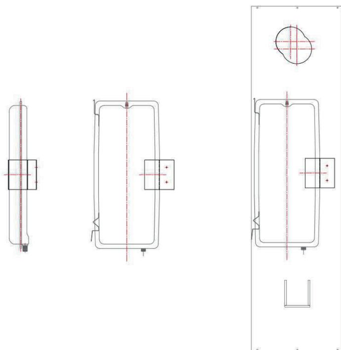
9. Montaggio finale del tubetto di allungamento carico vaso. Svitare il tappo superiore ed avviare il tubetto al suo posto in modo da avere più agio nel caso di controllo e/o carico del vaso di espansione.
