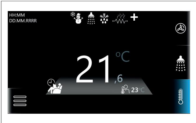
Funzione termostato, che usa la sonda interna al controllo remoto, per misurare la temperatura della stanza. Attivando questa funzione, la sonda interna sarà utilizzata per attivare o disattivare la pompa di calore.
