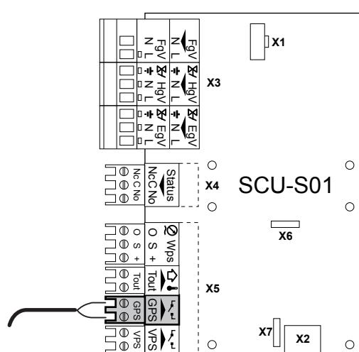
GPS (pressostato di minima gas):
