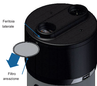
Fig. 20 – Dettaglio filtro di areazione
