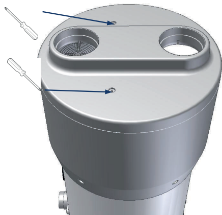
Fig. 16 – Rimozione copertura superiore
